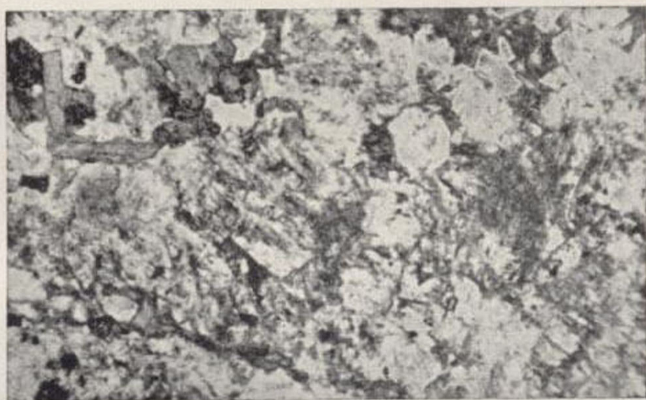
Fig. 15.—Sienita rojiza, Alella. L. ord. 20 d. Ortosa, oligoclasa, clorita y epidota.
