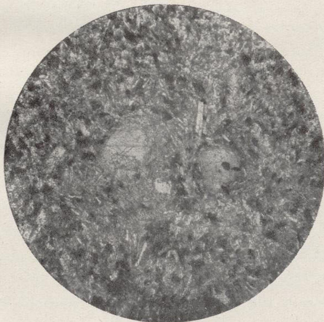
Fig. 59. — Porfidita andesítica del torrente de la Serviola, Teyá. N +, 40 d. Microlitos de oligoclasa y pasta felsítica.
