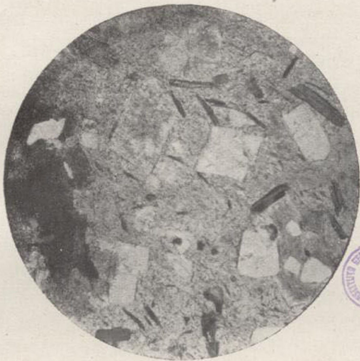
Fig. 49.—Pórfido cuarcífero (microgranito). Torrente de Arolas, cerca del Coll de Clau. L. ord., 20 d. Feldespato, cuarzo, biotita, epidota con clorita y magnetita.
