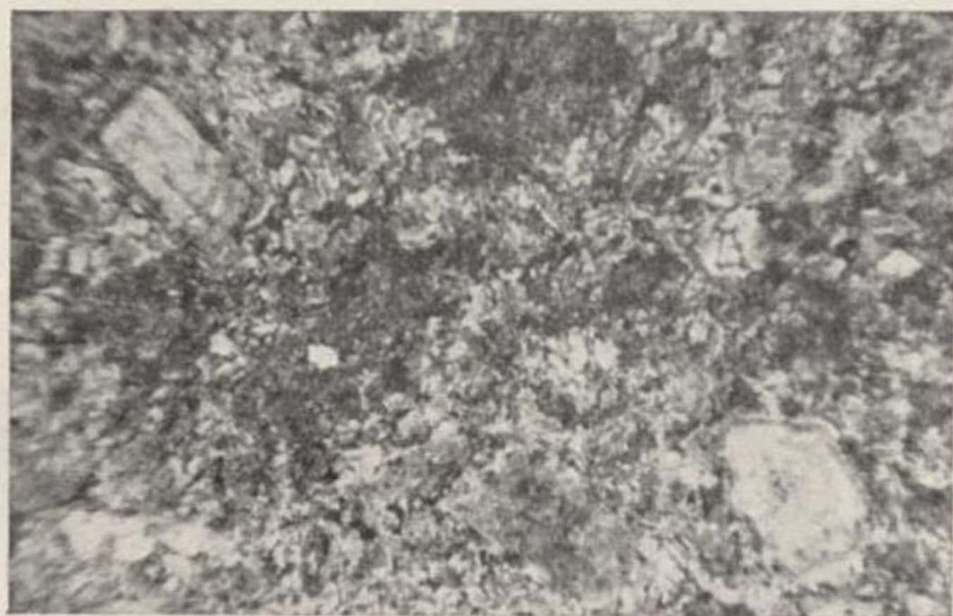
Fig. 35.—Pórfido diorítico (microdiorita). Llinás. Luz ord., 20 d. Fenocristales de plagioclasa y anfíbol cloritizado; pasta microgranuda de los mismos componentes y magnetita.
