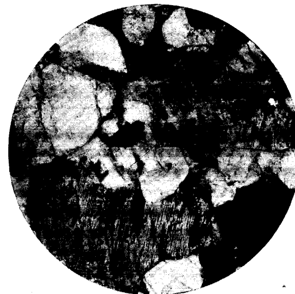
Fig. 7.—Granito apítico de San Andrés de Llavaneras. N +, 20 d. Ortosa, miclodina, pertita y cuarzo.
