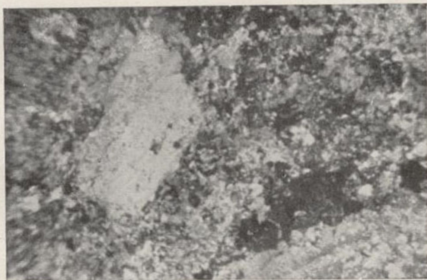
Figs. 23 y 24.—Pórfido granítico de Llinás Luz ord. y N +, 20 d. Fenocristal de oligoclasa alterada y de biotita muy ferrífera, sobre pasta microgranuda de cuarzo, feldespatos y biotita.
