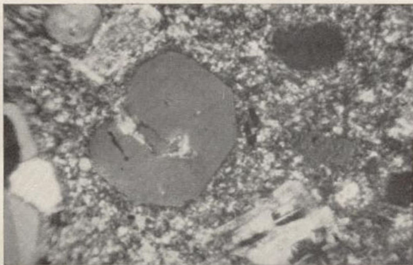
Fig. 34.—Pórfido diorítico. Cabrera de Mataró. N +, 20 d. Fenocristales de cuarzo, oligoclasa y biotita sobre pasta microgranuda de iguales componentes.
