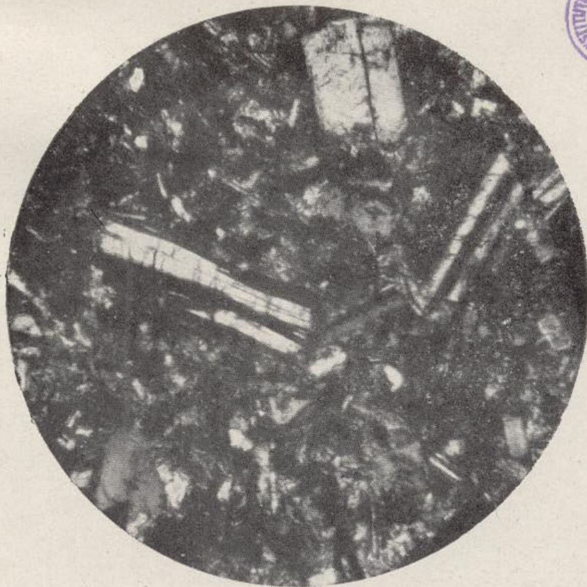
Fig. 69.—Porfirita diabásica de la roca de Xacó-Teyá. N +, 40 d. Labrador, magnetita, pasta de plagioclase y clorita.
