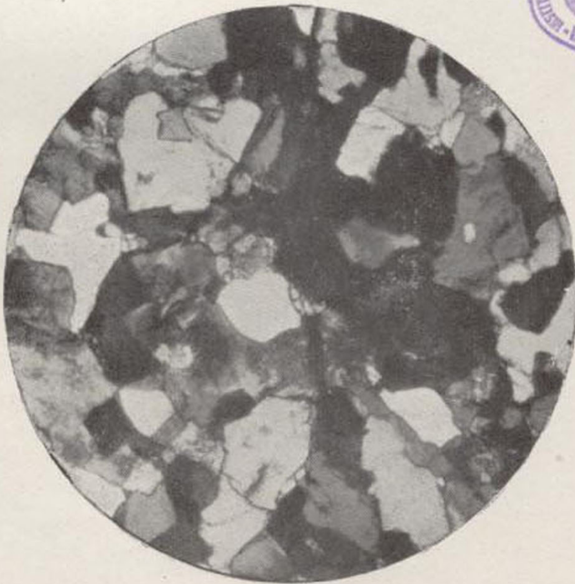
Fig. 39. — Aplita del camino de Can Gurría a San Mateo. N +, 40 d. Feldespatos, cuarzo, microclina y biotita.
