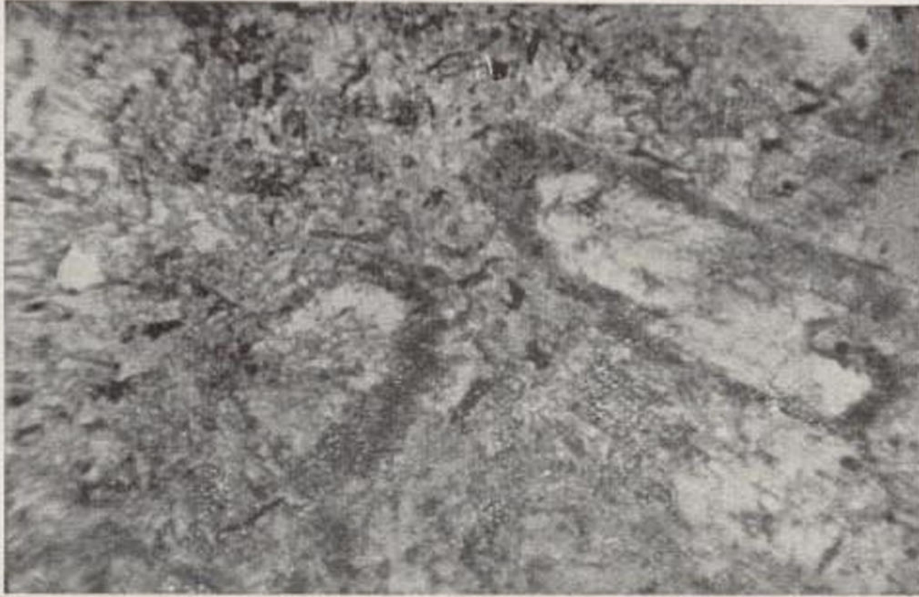
Fig. 38.—Microdiorita-augítica. Santa Inés de Malañés. L. ord., 20 d. Fenocristales de oligoclasa-andesina, de augita uralitizada y pasta granuda de plagioclasa, uralita, cuarzo y magnetita.
