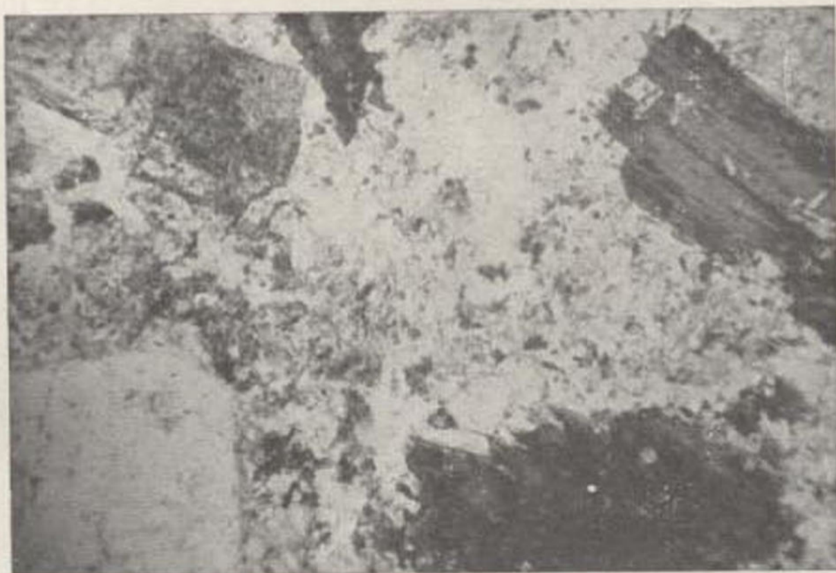
Fig. 22.—Pórfido granítico. Kilómetro 9-10 de la carretera de la Conreira de Montalegre a San Fausto de Capcentellas. Cuarzo, ortosa, oligoclasa, biotita. Luz ord., 20 d.
