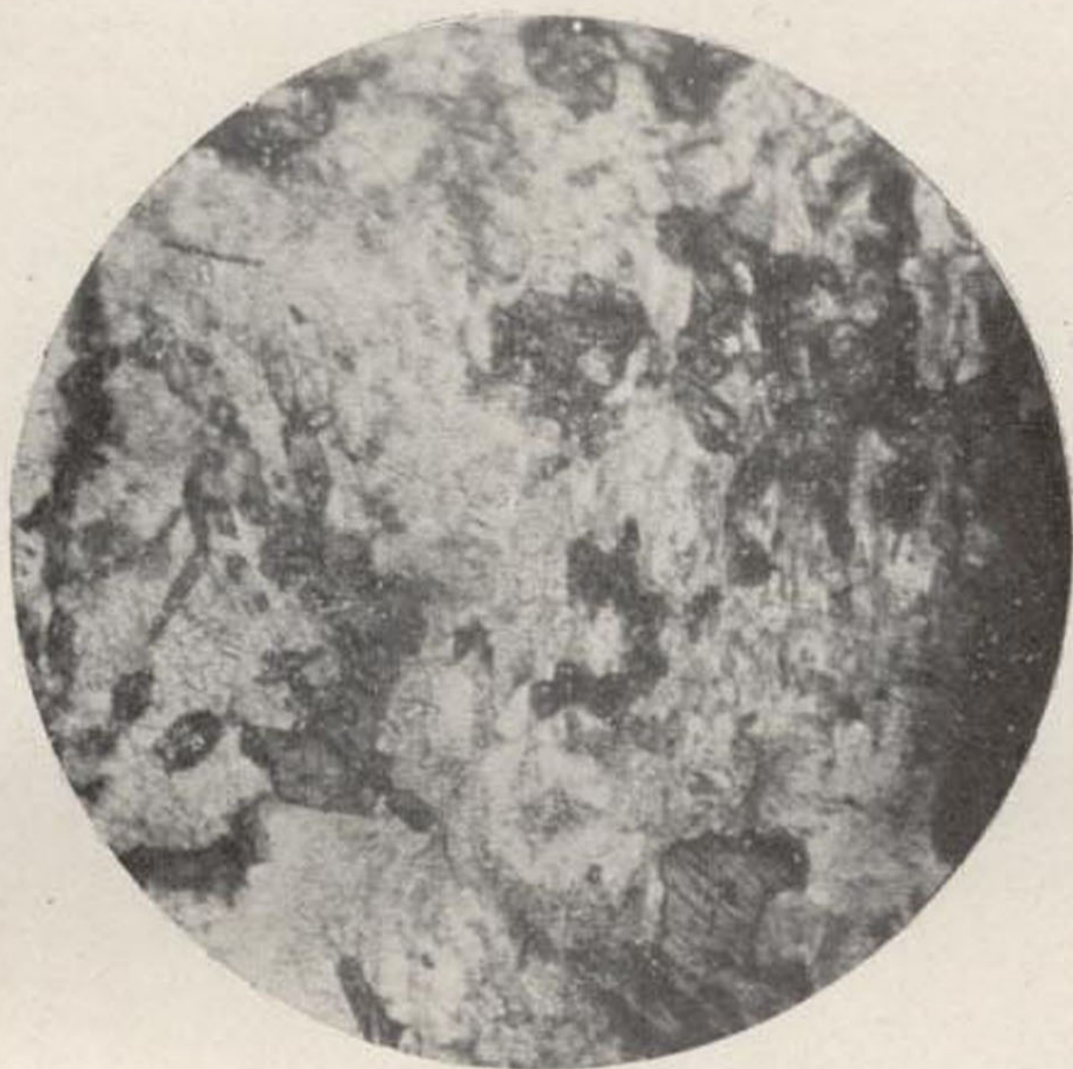
Fig. 11.—Sienita epidotífera del camino del cementerio al Maltemps. L. ord., 20 d. Feldespato alterado, epidota, calcita, cuarzo, magnetita.
